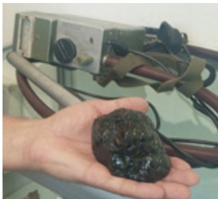
Bild 3: Handstück Uranerz Pechblende (Blasenerz) in nierig-kugliger Varietät mit Geiger-Müller-Zählrohr Unirad-Z des WTZ der SDAG Wismut im Bestand der Lagerstättensammlung der Wismut GmbH (Archiv Reiner Brumme, 2021)
