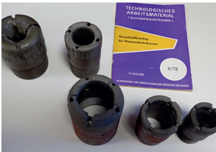
Bild 8: Diamant-Bohrkronen aus ZGB-Fertigung (v. l.): 59 mm, 46 mm, 76 mm, 59 mm, 46 mm (Archiv Klaus Michen)
