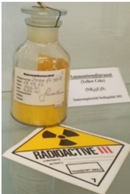
Bild 4: Natururankonzentrat 60 % (Ammoniumdiuranat, Filterkuchen bzw. Yellow Cake) aus dem Aufbereitungsbetrieb Seelingstädt der SDAG Wismut (Lagerstättensammlung Hartenstein der Wismut GmbH) – in dieser Form, jedoch zunächst in paraffinierten Pappbehältern, später in Kisten, noch später in Plastiktüten in 1,2-m 3 -Containern in die UdSSR, Sillamäe (Estland) zur Weiterverarbeitung exportiert (Archiv Reiner Brumme, 2021)
